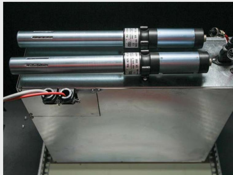
Rückansicht mit Löschgeneratoren
